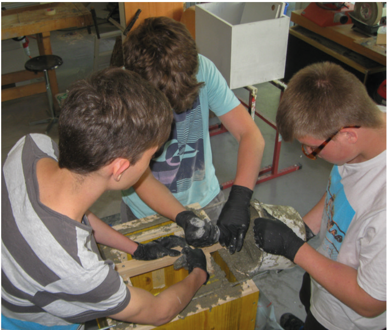
Drei Jugendliche am Betongießen einer Lautsprecherboxe
